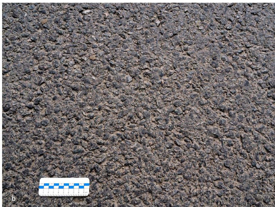
Rys. 7.2. Droga gminna w powiecie Malborskim z SMA 16 JENA (a) oraz zbliżenie powierzchni warstwy (b) (fot. K. Błazejowski)
