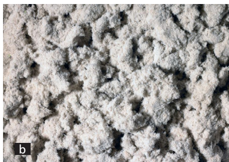
Rys. Z1.2. Klasyczne stabilizatory mastyksu: a) VIATOP Premium w formie granulatu, b) ARBOCEL ZZ/1 w formie włókien luzem (fot. Rettenmaier Polska sp. z o.o.)
