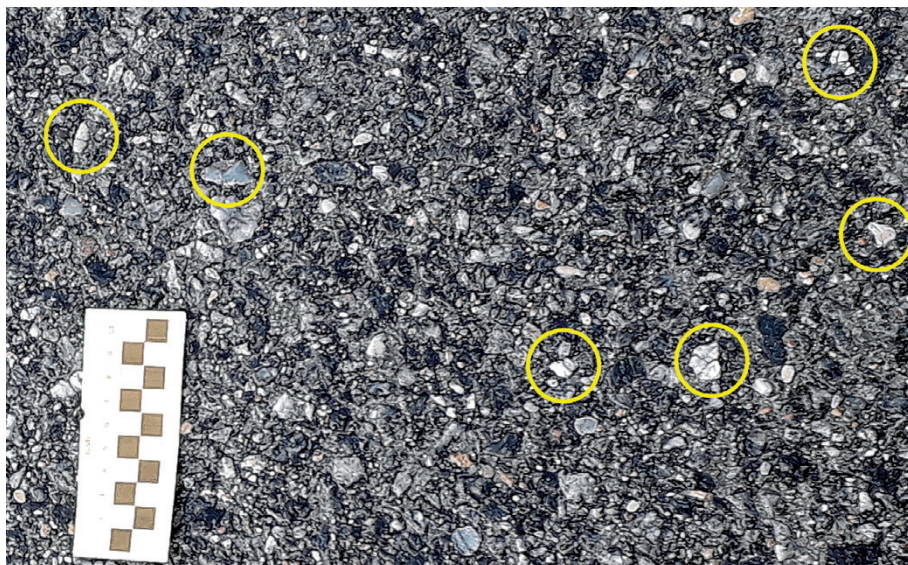
Rys. 3.6. Przykład spękanych ziaren „słabego” kruszywa grubego (fot I. Strugała)
