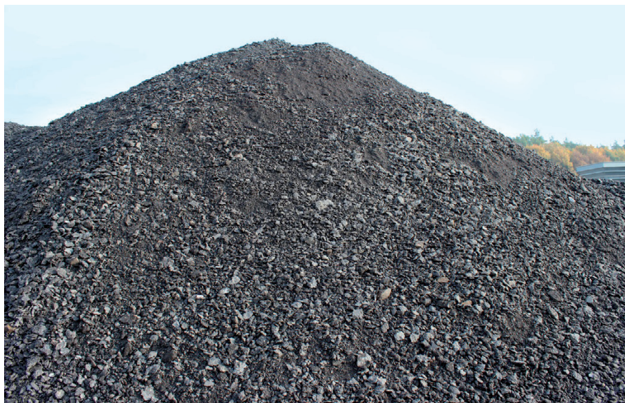
Rys. 5.1. Granulat asfaltowy, powstały z pokruszonego destruktu asfaltowego i odsianiu z niego kawałków większych od wymiaru U (fot. K.Błażejowski)
