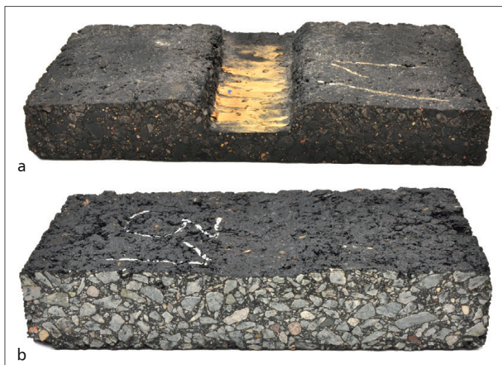
Rys. 4.2. Porównanie podatności na koleinowanie AC 11 S z asfaltem drogowym 50/70 i SMA 16 JENA z takim samym lepiszczem, a) próbka AC 11 S 50/70, b) próbka SMA 16 JENA 50/70 (fot. Cezary Szydłowski).
