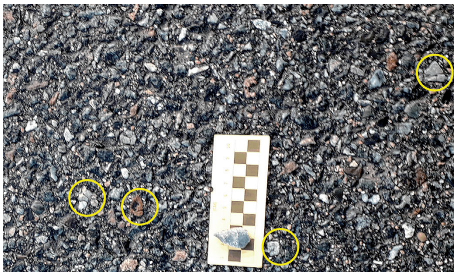
Rys. 3.7. Przykład spękanych ziaren „słabego” kruszywa grubego (fot I. Strugała)
