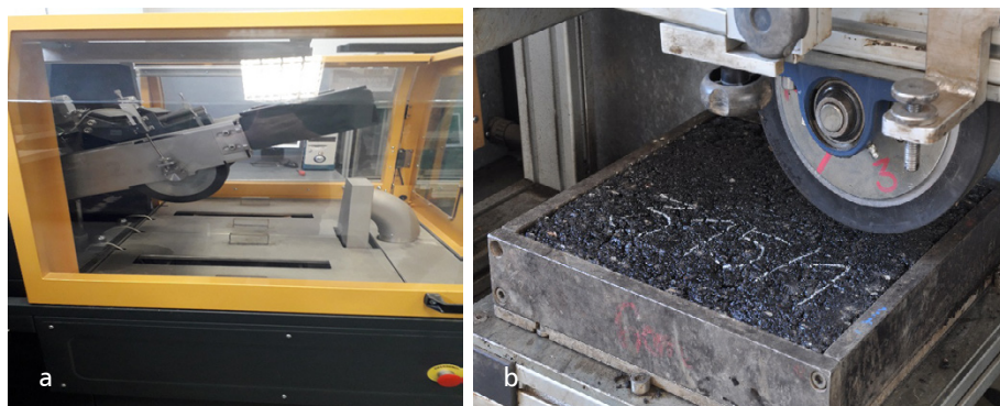
Rys. 4.1. Aparat do koleinowania wg PN-EN 12697-22, metoda B, w powietrzu, a) widok komory termostatycznej w aparacie bez założonej próbki, b) test koleinowania założonej próbki przygotowanej w laboratorium (fot. Cezary Szydłowski)
